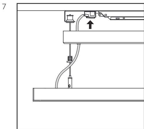
Проденьте кабель через отверстие крышки блока питания. Подключите кабель от светового модуля в соответствующую клеммную колодку. Укоротите кабель при необходимости.
