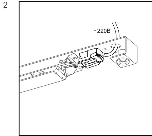
Подключите кабель питания и управления к вводной клеммной колодке.
