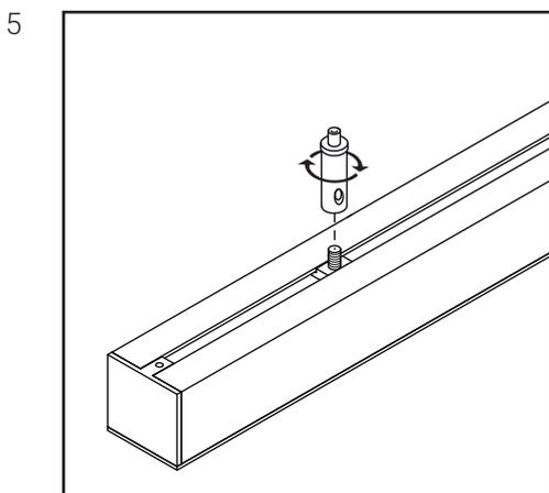
Зафиксируйте цанговые зажимы в корпусе светового модуля с помощью креплений на необходимом расстоянии. Проденьте тросы с шайбами через цанговые зажимы.
