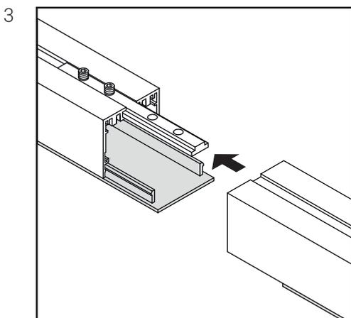
Соедините светильники с помощью специального крепления.
