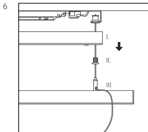
Проденьте тросы с шайбами через отверстия крышки блока питания (I.), винты (II.), в цанговые зажимы (III.). Отрегулируйте высоту подвеса светильника с помощью цанговых зажимов.
