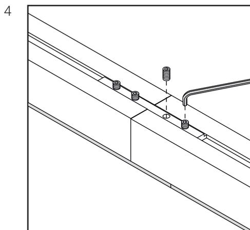
Закрепите светильники установочными винтами, идущими в комплекте.
