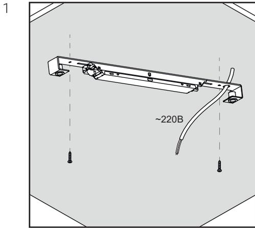
Установите пластину потолочного крепления на потолок с помощью отверстий. Кабель питания выведите через соответствующее отверстие в пластине.
