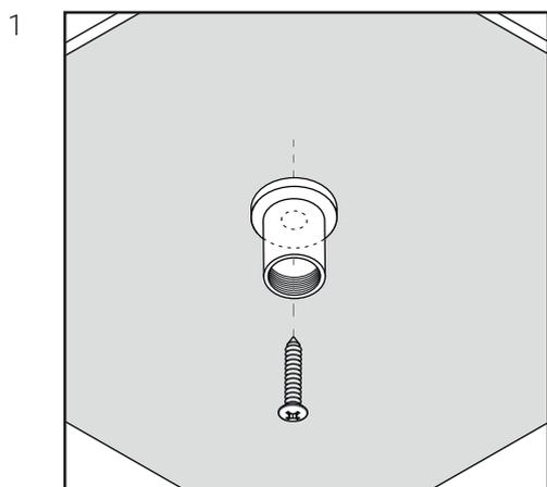
Установите крепежный элемент к потолку с помощью самореза.
