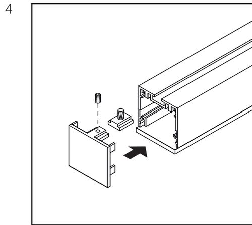
Проденьте крепежный профиль для цангового зажима в корпус светильника, затем закройте боковую заглушку и зафиксируйте её установочными винтами.
