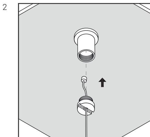
Продеть трос в винт и зафиксировать на крепежном элементе.
